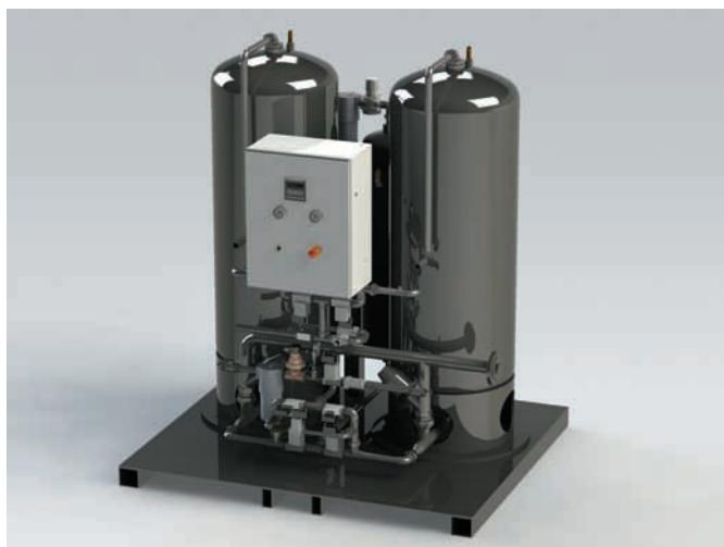
Установки короткоцикловой адсорбции, используемые для разделения газовых смесей с получением азота, кислорода и других компонентов с высокой концентрацией (от 95 до 99,9999%) позволяют разделять практически любой газ с высокой производительностью.
