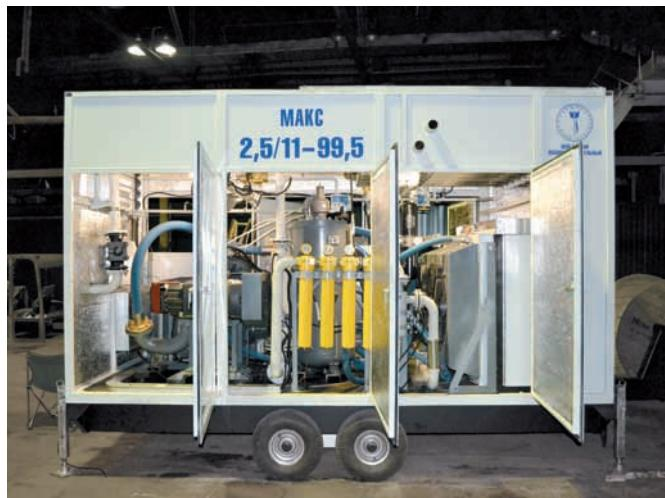
В зависимости от модификации, азотные компрессорные станции МАКС изготавливаются передвижными (на базе стандартных прицепов, полуприцепов, шасси грузовых автомобилей повышенной проходимости), на салазках.
