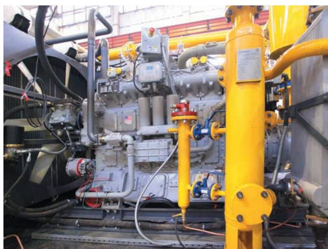
Модульные газовые компрессорные станции типа МГКС предназначены для утилизации ПНГ, а также сжатия других газов: атмосферный воздух, азот, сухой азот, сухой отбензиненный газ, природный газ, пропилен, этилен, водород, хлористый водород, пропан, бутан, метан, аргон и др.
